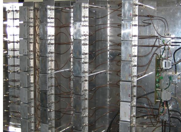
Fig. 4. Fotografía de la matriz de Butler. Se pueden apreciar los módulos de los híbridos de cuadratura y conmutadores de fase. También se aprecian los cables de interconexión.
